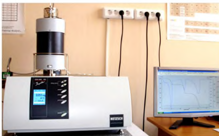
Рисунок 1 – NETZSCH STA 449 F3 Jupiter – прибор синхронного термического анализа
