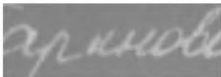
Рисунок 4 – Картина люминесценции в красной зоне спектра штрихов, нанесенных чернилами для авторучек черного цвета марки «Parker»
