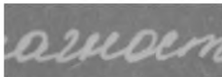
Рисунок 5 – Картина люминесценции в красной зоне спектра штрихов, нанесенных чернилами для капиллярных ручек черного цвета марки «Stabilo»
