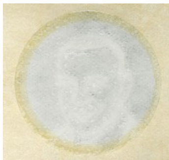
Внешний вид окна Viewsafe с накладкой в виде прозрачной пленки на месте расположения водяного знака в гибридной банкноте Марокко номиналом 25 дирхамов
