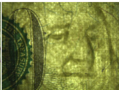
Фрагмент портретного двухтонового водяного знака на банкноте США номиналом 100 долларов (съемка в проходящем видимом свете)
