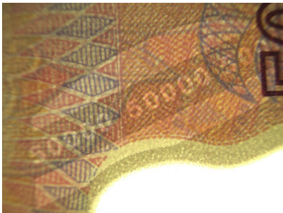
Двухтоновое теневое изображение (полосовой псевдоводяной знак) в полимерной банкноте Вьетнама номиналом 50 000 донгов (съемка в проходящем видимом свете)
