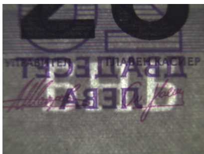
Филигранный водяной знак и микрорельеф бумаги от «сукна и сетки» в банкноте Болгарии номиналом 20 левов (съемка в проходящем видимом свете)
