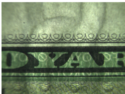
Фрагмент полосового водяного знака в виде якорной цепи в банкноте Фарерских островов (Дания) номиналом 100 крон
