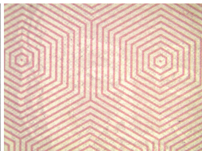
Полутоновое теневое изображение (полутоновой псевдоводяной знак) в полимерной банкноте Вьетнама номиналом 50 000 донгов (съемка в отраженном видимом свете)
