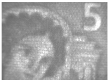
Комбинированный водяной знак филигранный и полутонный в евробанкноте номиналом 5 евро (съемка в проходящем ИК-свете)
