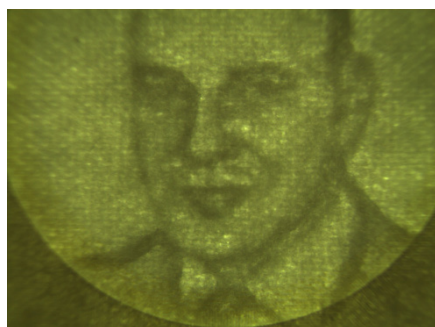
Фрагмент собственно водяного знака в гибридной банкноте Марокко номиналом 25 дирхамов (съемка в проходящем видимом свете)
