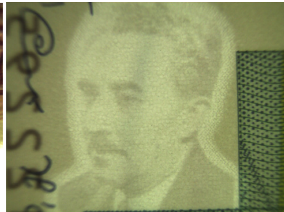
Полутоновое теневое изображение (полутоновой псевдоводяной знак) в полимерной банкноте Израиля номиналом 20 шекелей (съемка в проходящем видимом свете)
