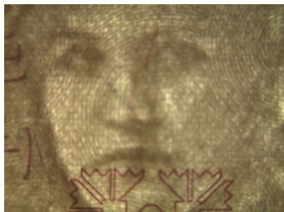
Фрагмент портретного полутонного полосового водяного знака в банкноте Норвегии номиналом 100 крон (съемка в проходящем видимом свете)
