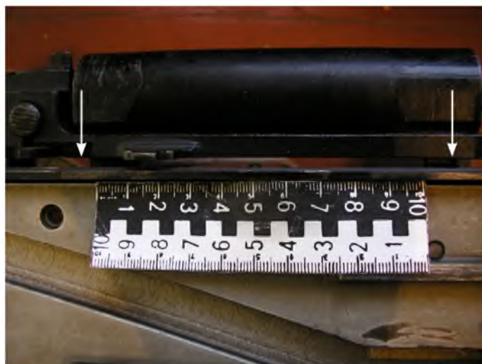
Фото 1 – Общий вид ударно-спускового механизма перед началом исследования (вид сверху). Между корпусом ударно-спускового механизма и боковой стенкой ствольной коробки виден зазор (указано стрелкой), которого при правильной сборке не должно быть
