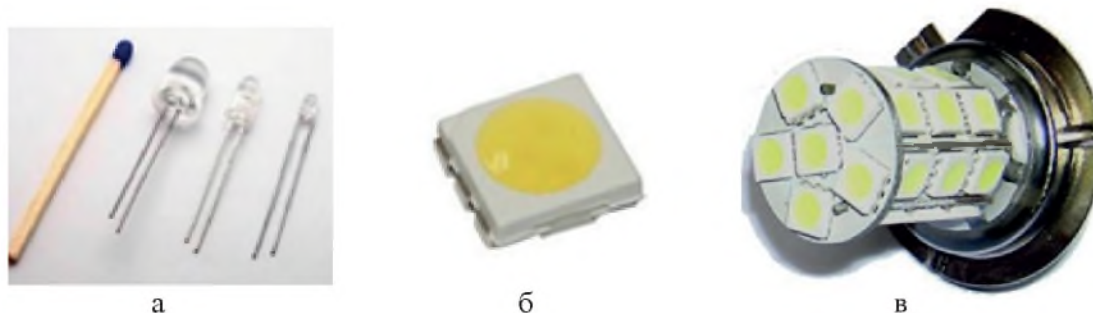
Рисунок 2 – Индикаторный светодиод (а), отдельный осветительный светодиод поверхностного монтажа SMD (б), автомобильная светодиодная система или LED-лампа с цоколем H1 (в)
