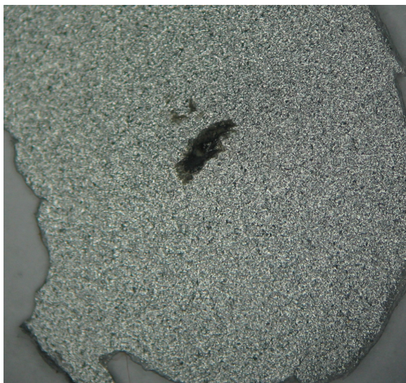
Рисунок 7 – Сквозное повреждение в центре вздутия
