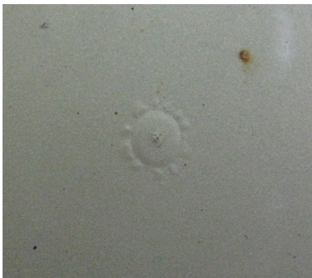
Рисунок 1 – Вздутие ЛКП на кузове автомобиля «Opel Astra»
