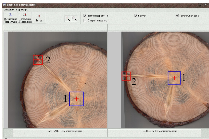
Рисунок 1 – Сравнение двух спилов древесины ели обыкновенной: 1 – центр спила, 2 – доминирующий элемент
