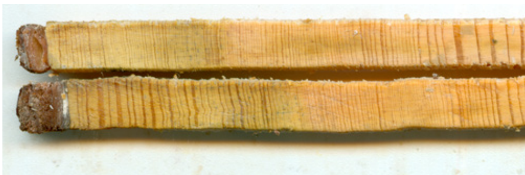
Рисунок 4 – Пример буровых кернов сосны обыкновенной с чрезвычайно узкими годовыми слоями ( <0,01\text{ мм} )
