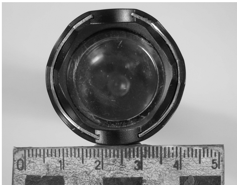
Рисунок 2 – Контактная травмирующая поверхность ЭШУ
