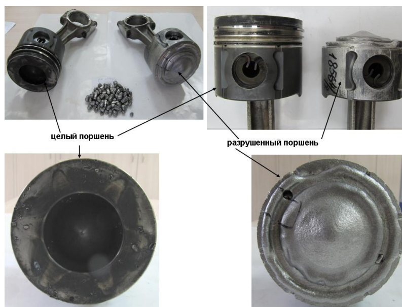
Рисунок 1 – Общий вид поршней (целого и разрушенного) дизельного двигателя грузового автомобиля Mitsubishi
