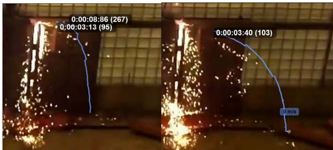
Рисунок. Скриншот ролика сварки, обработанного программой «Kinovea»
