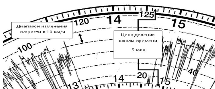
Рисунок 1. График скорости движения на тахограмме аналогового тахографа
