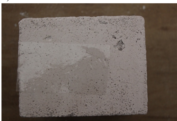
Рисунок 1. Визуальные признаки повреждения образцов ячеистого газобетона при температурных воздействиях: а – 100°C; б – 200°C; в – 300°C; г – 400°C; д – 500°C; е – 600°C; ж – 700°C; з – 800°C; и – 900°C; к – 1000°C
